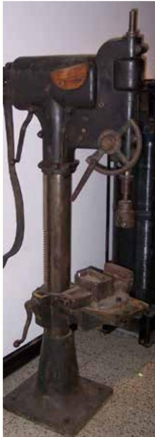
Ständerbohrmaschine mit Transmissionsantrieb
